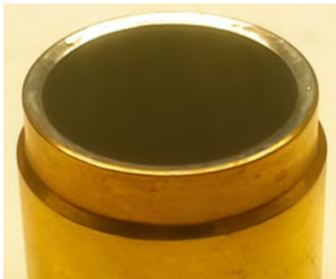
Рис. 2. Фрагмент металлического корпуса фотоприемника с впаянным входным окном.
